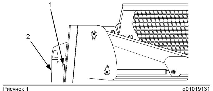
1. Для открытия дверцы доступа (2) к двигателю потяните за рычаг (1).
