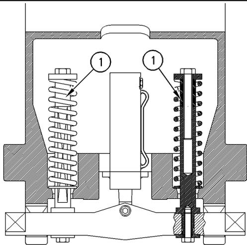
2. Полностью заверните шпindel по часовой стрелке . Нанесите смазку на шпindel в обеих смазочных точках (1) так, чтобы смазка показалась в выпускном отверстии (2) .
